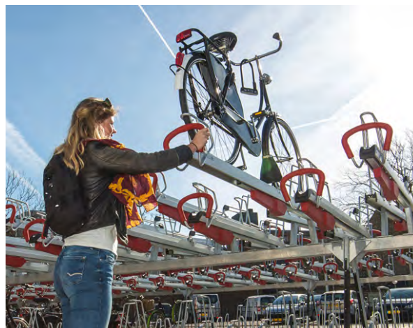
Minimale Bedienungskraft durch Gasdruckfeder
