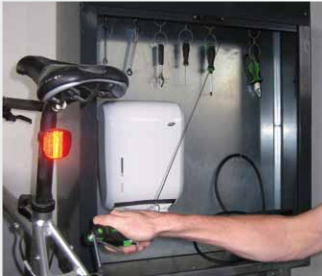
Das Werkzeug ist mittels Seilzug an der Servicestation montiert.
